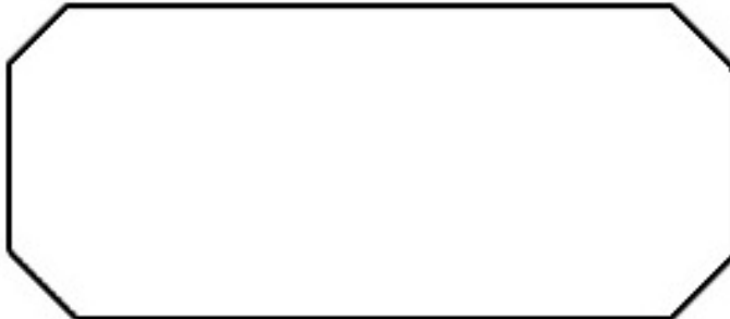
Köşeleri 90^\circ kesilmiş loop alanı ( ÖNERİLMEZ )
