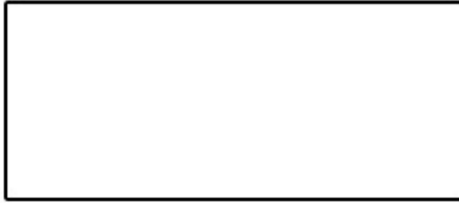
Köşeleri 90^\circ kesilmiş loop alanı ( ÖNERİLMEZ )
